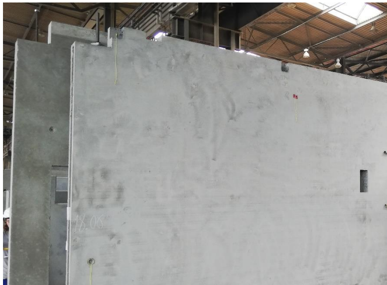
Zdjęcie 1.1 Dopuszczalne różnice koloru w technologii betonu barwionego w masie
